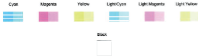
图 9-2 包含缺陷的色块示例
